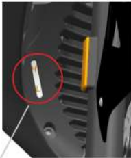
Mirilla de comprobación del nivel de refrigerante en el vaso de expansión
