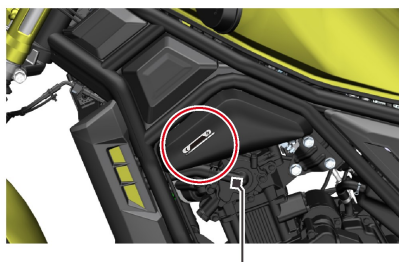
Cubierta del vaso de expansión
