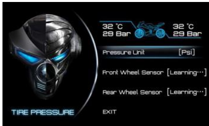
Figura 5: Función de control de la presión de los neumáticos
