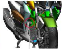
Cubierta acceso al radiador
