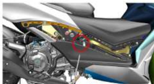
Cubierta lateral para acceder al vaso expansión
